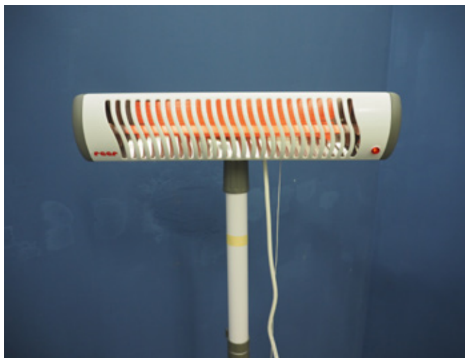
Blick in ein Kinderzimmer, in dem es zum Brandausbruch kam: Neben dem Wickeltisch steht der schadenursächliche Wärmestrahler. Rechts: Ein Vergleichsgerät wird im Elektrolabor untersucht.
