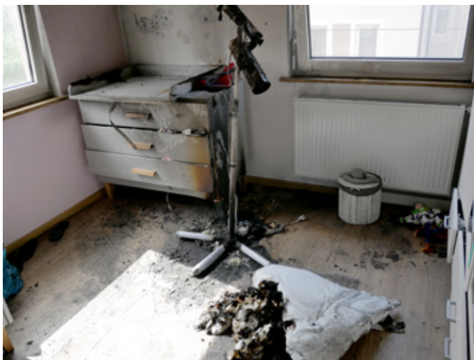
Blick in ein Kinderzimmer, in dem es zum Brandausbruch kam: Neben dem Wickeltisch steht der schadenursächliche Wärmestrahler. Rechts: Ein Vergleichsgerät wird im Elektrolabor untersucht.
