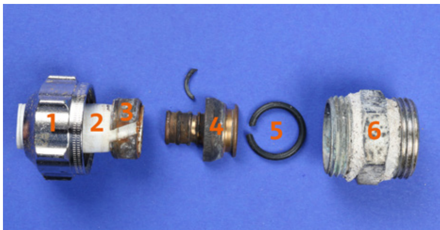
Komponenten einer Konusverschraubung: Der Überwurf (1) und der Klemmring (3) werden auf das Rohr (2) gesteckt und das Rohrende auf einen Stützkörper (4), der mit einem O-Ring (5) abdichtet. Rechts ist eine Kupplung (6) zum Anschluss an die weitere Leitung zu sehen.
