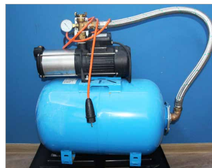
Ein Hauswasserwerk wartet auf die Laboruntersuchung: Bei diesem war nur eine Schraubverbindung undicht.
