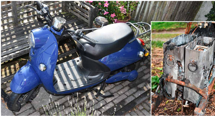
Ein UNU-Roller, dessen Akku in der Wohnung des Betroffenen durchgegangen sind. Das kleine Bild zeigt die Akkus eines Rollers, der durch einen Defekt im Akku verbrannt ist.
