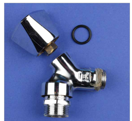
Das Ventilkopfstück ist abgebrochen.
