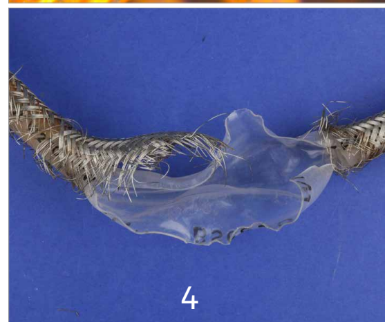
1. Bei der Montage wurde das notwendige Stützgeflecht entfernt. 2. Das Geflecht wurde bei der Produktion nicht weit genug in die Presshülse eingeschoben. 3. Korrodierte Drähte eines Stützgeflechts. 4. Durch einen Reiniger wurde das Geflecht zerstört und der Innenschlauch platzte.
