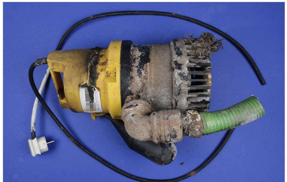
Die Pumpe aus dem ersten geschilderten Schaden ist deutlich verschmutzt. Ein Kurzschluss hatte schließlich zum vollständigen Ausfall geführt.
