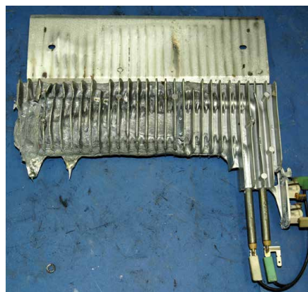
Das Aluminiumgehäuse des Heizregisters ist geschmolzen.
