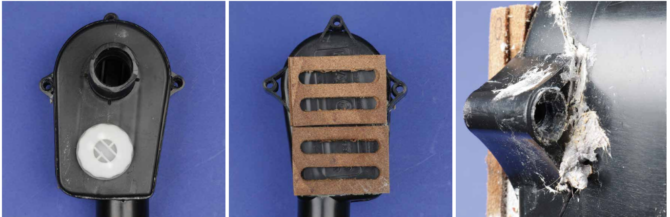
Der Siphon aus Kunststoff (Bild links) wurde auf der Rückseite mit Schallschutzplatten hinterfütert, wie auf dem mittleren Bild zu sehen ist. Die Detailaufnahme rechts zeigt Risse im Gehäuse im Bereich der Befestigungsösen.
