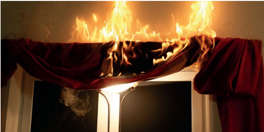
Kommt es durch Leuchtmittel zum Brandausbruch, dann wurden meistens die Mindestabstände zu brennbaren Materialien nicht eingehalten. Foto: IFS
