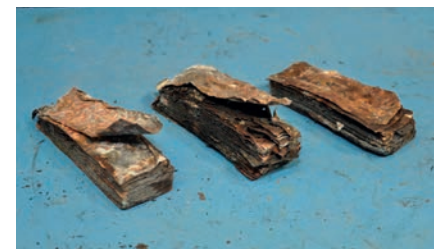
Die Lithium-Akkuzellen aus einem verbrannten MPB150.
