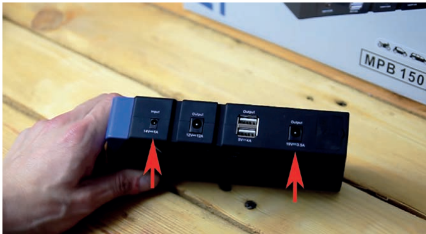
Bei diesem Kunzer MPB150 wurde die Bauart bereits geändert und das Problem beseitigt: Die Input- und die Outputbuchse sind hier unterschiedlich groß.
