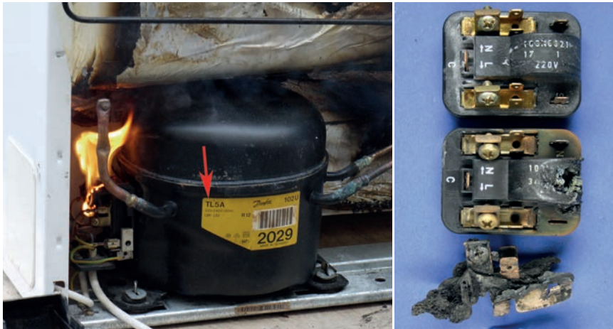
Auf der Geräterückseite ist der Kompressor mit dem gelben Typenschild und der Modellbezeichnung (Pfeil) zu sehen. Rechts: drei Relais mit unterschiedlichem Zerstörungsgrad.
