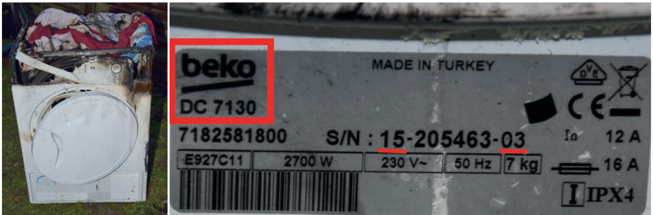
Einer der vom IFS untersuchten Wäschetrockner; wann das Gerät produziert wurde, ist anhand der Seriennummer nachvollziehbar. Dieser Trockner wurde demnach im März 2015 hergestellt. Unter dem Markennamen ist die Modellbezeichnung abgedruckt, hier DC 7130.
