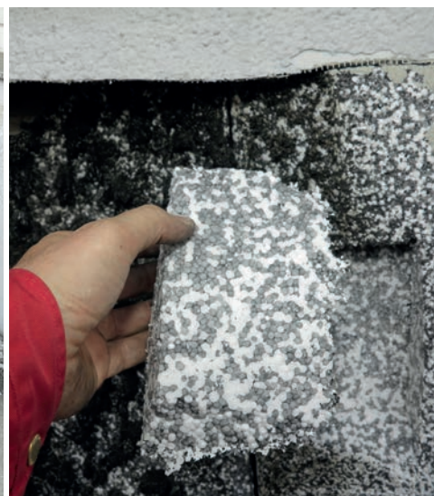
Hier ist auf einem Balkon die gedämmte Fassade eines Mehrfamilienhauses in Brand geraten. Rechts: Der Gutachter entnimmt eine Probe des Dämm-Materials.
