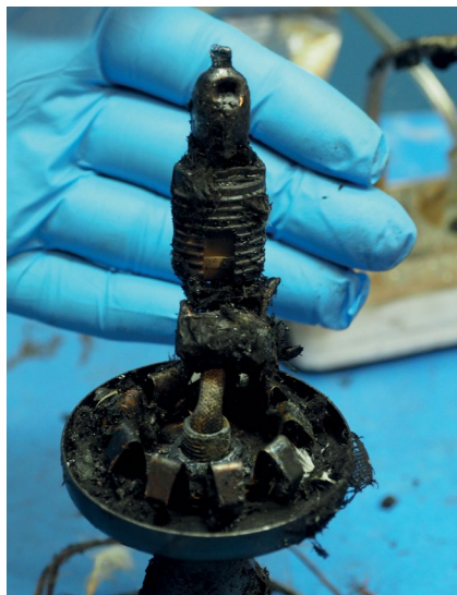
Am Halogenleuchtmittel, das im Elektrolabor untersucht wird, kleben Textilfasern. Rechts sind die Brandspuren im Schlafzimmer abgebildet.
