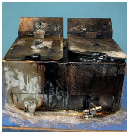
Im rechten Becken der Fritteuse von „Royal Catering“ kam es zum Brandausbruch.
