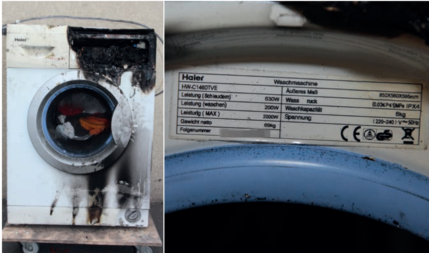
An der abgebildeten Waschmaschine, die vom IFS untersucht wurde, ist der Brandschwerpunkt deutlich zu erkennen. Das Typenschild ist bei geöffneter Tür über der Trommelöffnung zu sehen; direkt unter dem Herstellernamen steht die Modellnummer.
