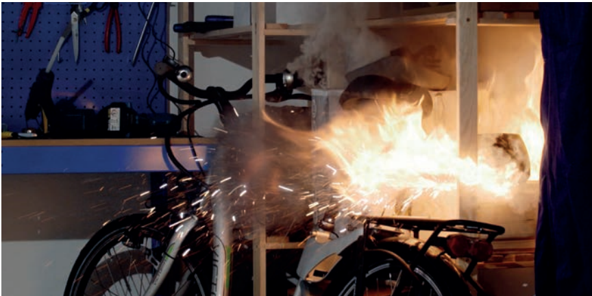
Der Akku-Block eines Elektrofahrrades hat zu brennen begonnen.
