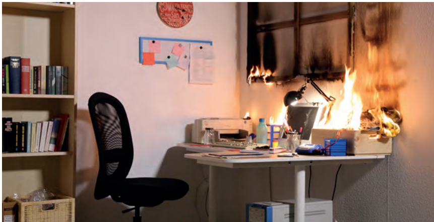
Aus dem neuesten Schadenverhütungsvideo des IFS: Auf dem Schreibtisch gerät beim Laden der Akku eines Multikopters in Brand.
