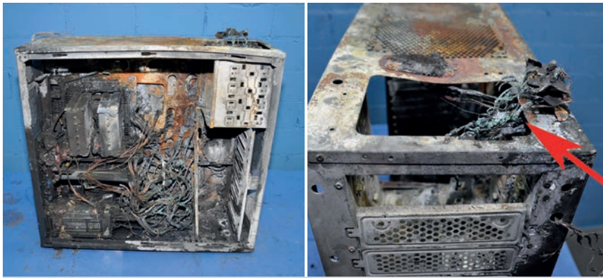
Ein Blick in das geöffnete Computergehäuse; rechts ist der Brandschwerpunkt mit den Anschlusskabeln für die Dockingstation abgebildet.
