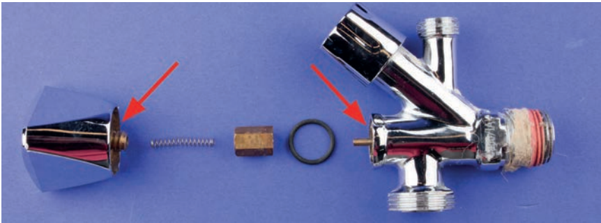
An diesem Eckventil ist das Ventil-Kopfstück aus Messing gebrochen.
