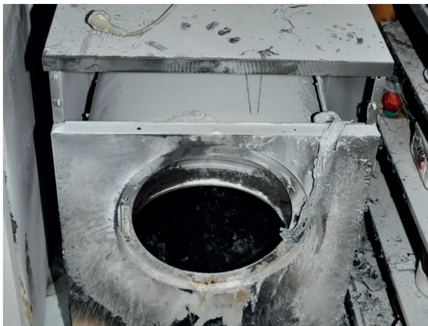
Dieser vom IFS untersuchte Wäschetrockner ist noch relativ gut erhalten. Man kann erkennen, dass es im Inneren der Trommel gebrannt hat.
