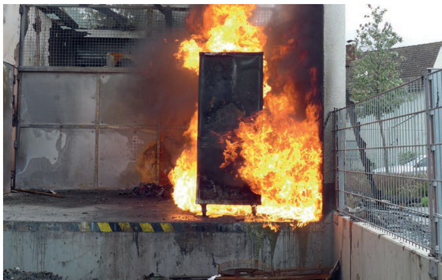
Brandversuch auf der Laderampe des Supermarktes: In wenigen Minuten ist der rollbare Thermocontainer von Flammen umschlossen. Foto: IFS
