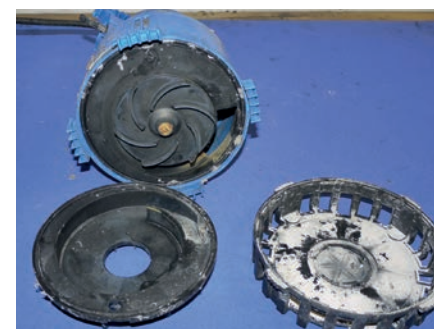
Eine zerlegte Pumpe aus einem weiteren Schaden: Korrosionsspuren und Kalkablagerungen durch das Regenerationswasser.
