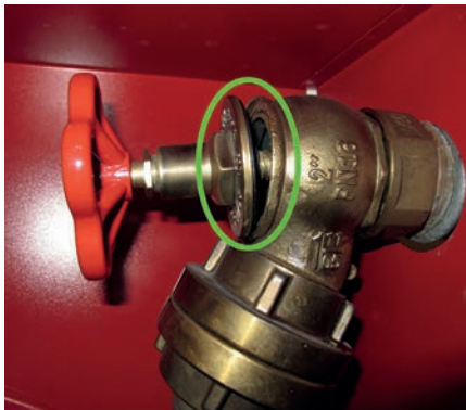
Das linke Bild zeigt den Blick in den Wandhydranten: Das Gewinde des Ventiloberteils ist fast rundum gebrochen. In der Mitte ist die Minimalstärke und rechts die Maximalstärke des asymmetrischen Gewindes abgebildet.
