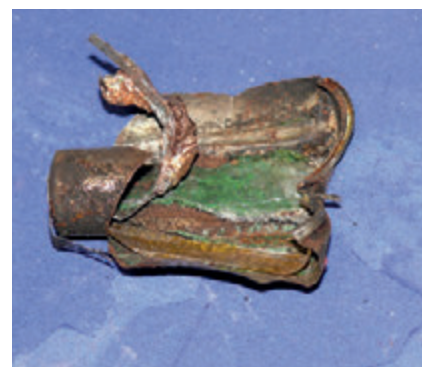
Explodierte Zelle eines Lithium-Ionen-Akkus Foto: IFS
