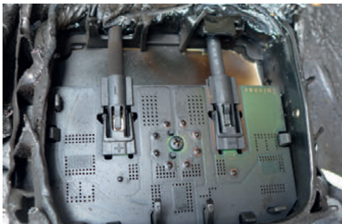
Das linke Bild zeigt eine unbeschädigte Platine in einer nur von außen brandbetroffenen Anschlussbox der PV-Anlage. An den Resten der rechts abgebildeten Box ist der herausgebrannte Kontakt zu erkennen, an dem es zur Überhitzung kam. Fotos: IFS
