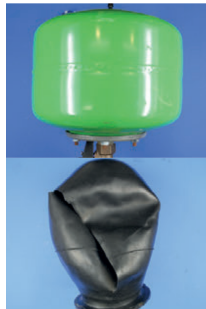
Das Ausdehnungsgefäß (oben) und die gerissene Membran Fotos: IFS
