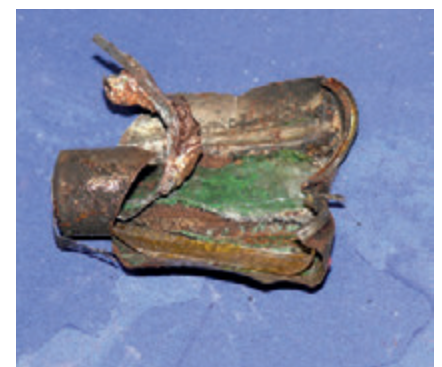
Explodierte Zelle eines Lithium-Ionen-Akkus Foto: IFS
