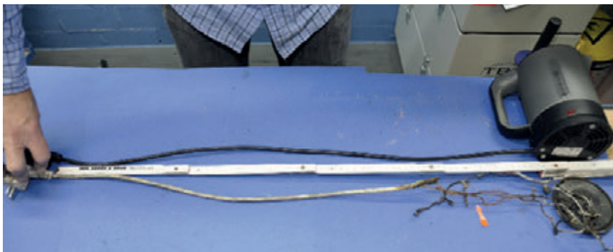
Die Reste des verbrannten Wasserkochers und ein Vergleichsgerät werden im Elektrolabor untersucht. Foto: IFS
