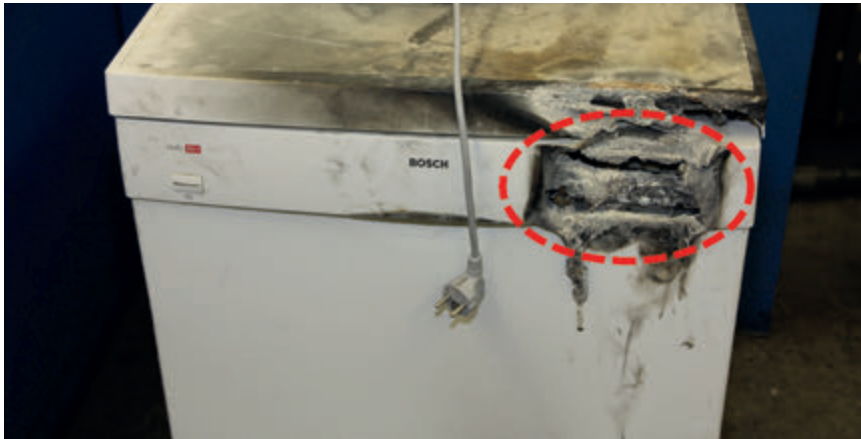
An diesem im IFS untersuchten Geschirrspüler ist der Schadensschwerpunkt im Bereich der Bedienblende gut zu erkennen. Foto: IFS
