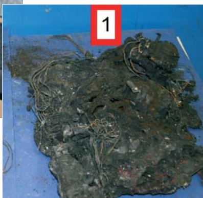
Brandschaden in einer Küche: Rechts sind die Reste des Kaffeevollautomaten zu sehen, der das Feuer verursacht hat.
