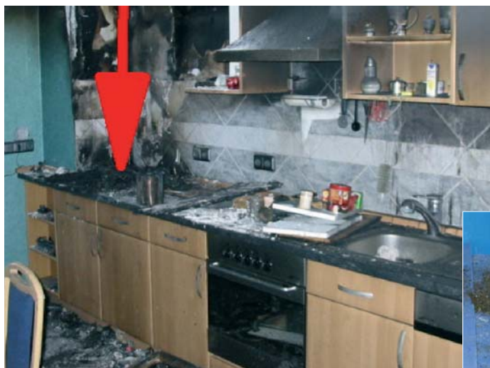
Brandschaden in einer Küche: Rechts sind die Reste des Kaffeevollautomaten zu sehen, der das Feuer verursacht hat.
