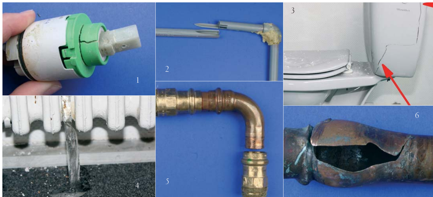
Alle hier gezeigten Schäden entstanden durch Frosteinwirkung: 1. gebrochene Kartusche einer Waschtisch-Armatur, 2. gesplittertes PVC-Rohr, 3. geplatzter WC-Spülkasten, 4. geplatzter Heizkörper, 5. getrennte Kupferrohr-Verbindung, 6. aufgeplatztes Kupferrohr
