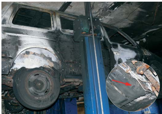
Der Van steht nach dem Feuer noch auf der Hebebühne. Das kleine Bild zeigt den Tank mit dem Bohrloch (Pfeil).
