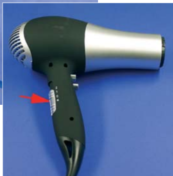
Oben: Der Schiebeschalter des verbrannten Föhns (oben) ist zwischen „Aus“ und „Stufe 1“ verbacken, der des Vergleichsföhns befindet sich in „Stufe 1“. Rechts: Vergleichsgerät, der Pfeil markiert den Schiebeschalter.
