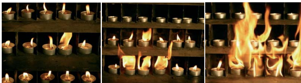
Im Laborversuch zeigt sich, wie sich der Brand in der Lichterstation der Kirche entwickelt hat.
