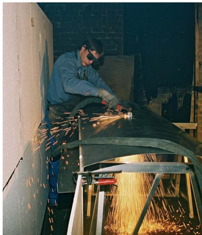
Brennschneidarbeiten im Brandversuchshaus des IFS
