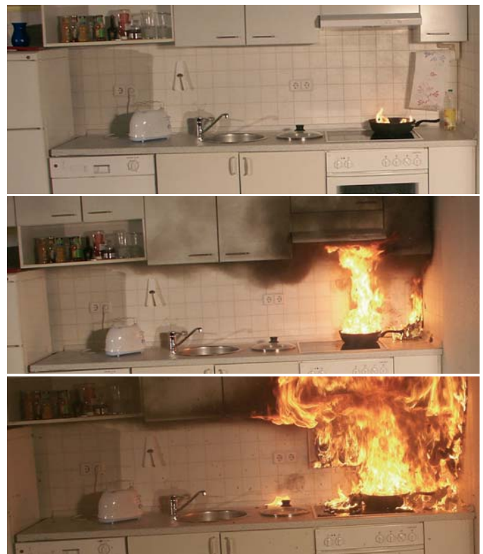
Im Brandhaus des IFS in Kiel wird ein Fettbrand nachgestellt.
