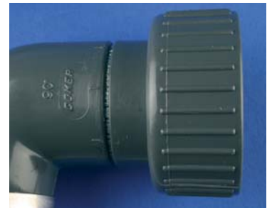
Am Verbindungsstück ist die Klebeverbindung auseinandergedrückt
