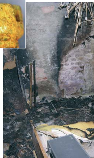
Ein kraterförmiger Materialabtrag an der Seite des Schraubenkopfes (kleines Bild) und der Brandtrichter im Schlafzimmer
