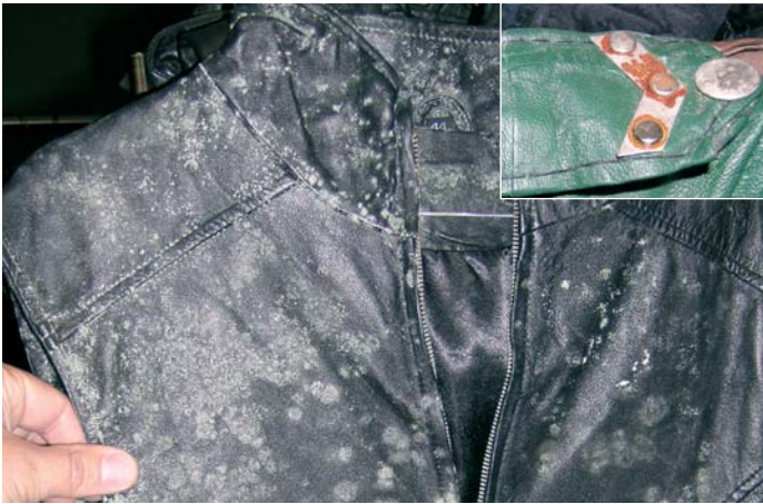
Die Aufnahmen zeigen beispielhaft massiven Schimmelbefall und ausgeprägte Korrosions- spuren (kleines Bild) auf zwei der asservierten Lederjacken. Fotos: IFS
