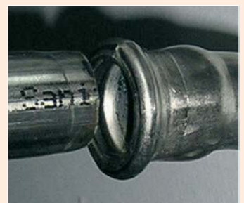
Die Pressmarken liegen am Ende des Leitungsabschnittes Foto: privat
