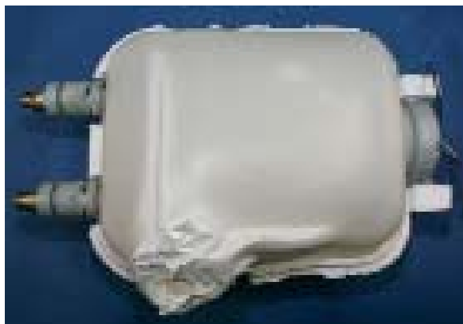
Der aufgeplatzte Innenbehälter eines drucklosen Warmwasserspeichers
