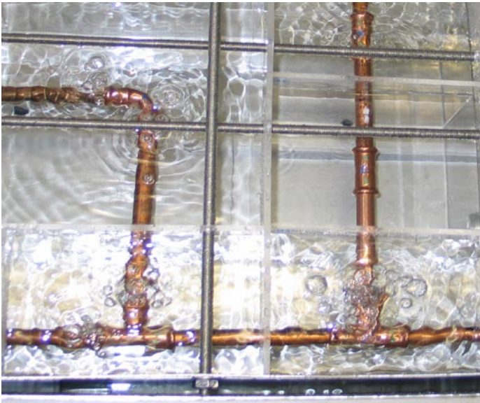
Dichtigkeitsprüfung im Wasserbad: Nicht alle der hier geprüften Pressverbindungen entsprechen den Anforderungen.
