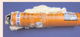
Klare Spuren äußerer Krafteinwirkung
