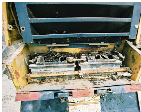
Der Radlader, der die Halle kurz vor dem Feuer verlassen hatte. Rechts: Die Schadensursache war im Batteriekasten zu finden.
