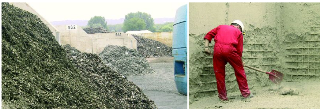
Der Lagerort der Metallspäne auf dem Gelände des Recyclingbetriebes. Rechts: Im noch heißen Brandbereich wird die Zementschicht entfernt.
