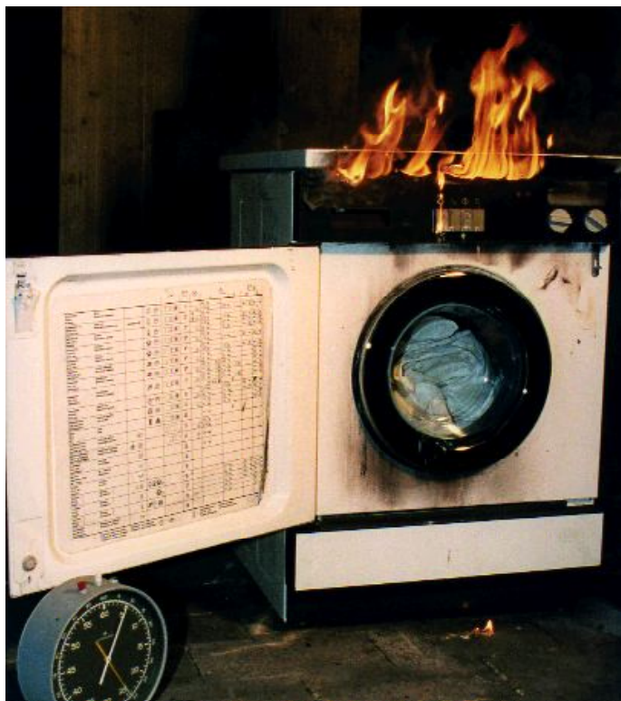
Im Brandraum werden alltägliche Schadenfälle aus dem Haushalt nachgestellt. Dabei zeigt sich, wann beispielsweise der Aufsichtspflicht nicht nachgekommen wurde. Foto: IFS
