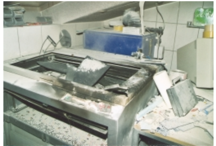
Feuer an einer Laserschneidmaschine: Der energiereiche Laserstrahl hatte das Werkstück aus Acryl-Kunststoff entzündet.
