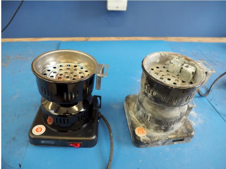
Shisha-Kohleanzünder in der hohen Bauform. Das rechte Gerät stammt aus einem untersuchten Brandfall, das linke wurde für Brandversuche erworben.
