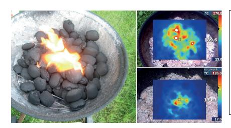
Brandversuch mit einem Kugelgrill: Die Infrarotbilder zeigen die Wärmeentwicklung im Laufe des Versuches.
