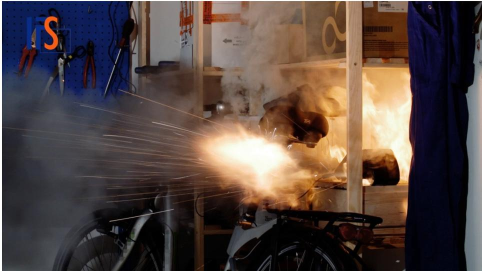
Der Akku eines Elektrofahrrades geht thermisch durch.
