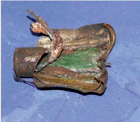
Explodierte Zelle eines Lithium-Ionen-Ak- kus Foto: IFS
