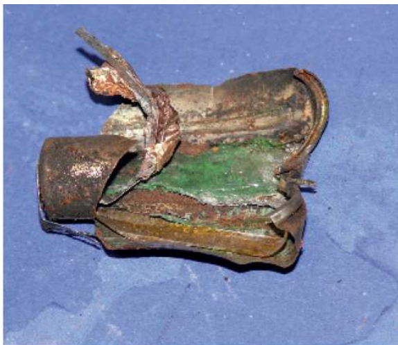
Explodierte Zelle eines Lithium-Ionen-Ak- kus Foto: IFS
