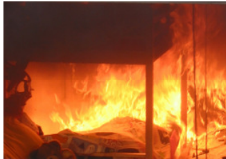
Abbildung 2 Drei Minuten nach Brandausbruch: Das Feuer hat ein Ausmaß erreicht, in dem es nicht mehr durch Hausmittel löscherbar ist. Auch Löschversuche mit einem Feuerlöscher sind jetzt nur noch wenig aussichtsreich. (Quelle: Bundesanstalt für Materialforschung und -prüfung)
