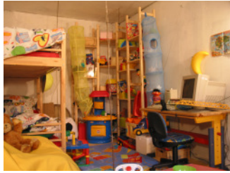
Abbildung 1 Typisches Kinderzimmer vor einem Brandversuch: Viele Spielzeuge aus Kunststoff, der PC und der insgesamt kleine Raum, auf den sich die mögliche Brandlast konzentriert. (Quelle: Bundesanstalt für Materialforschung und -prüfung)
