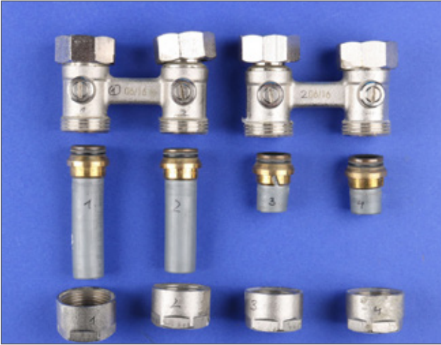
Die Heizkörperanschlussblöcke mit den gelösten Verbindungen
