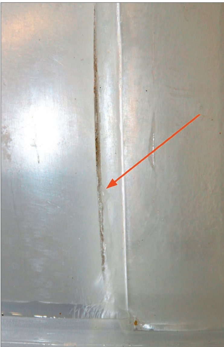
Bild 5: Detailaufnahme des Risses im Innenbehälter des schadenursächlichen Warmwasserspeichers
