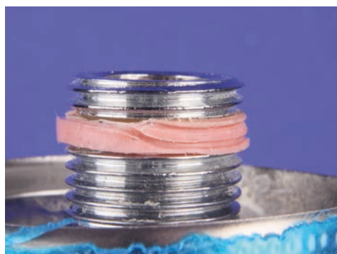
Bild 1: Das dem IFS zur Schadenursachenermittlung übersandte Kombi-Eckventil
