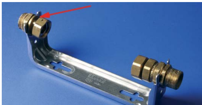
Der Gewindestutzen auf der starren Seite der Anschlussverschraubung ist gebrochen.
