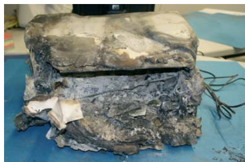
Das Faxgerät bei der Untersuchung im Elektrolabor: Es weist an der Vorder- und Oberseite Brandzehrungen auf.
