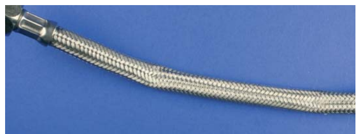
Knickstellen im Schlauch sind deutlich erkennbar.
