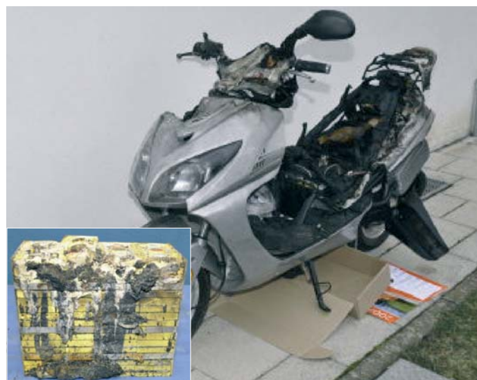
Der Roller; kleines Bild: die betroffenen Zellen des Akkublocks. Fotos: IFS
