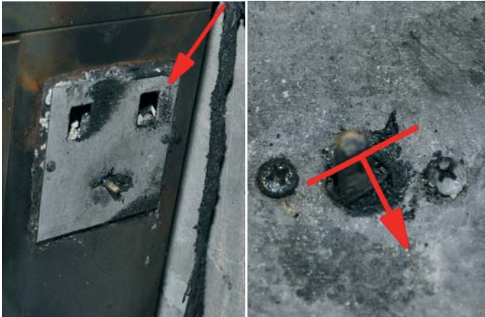
Die Bedienelemente des Gärschrankes (links): Die Kunststoffteile sind fast vollständig verbrannt. Die Achse des Reglers (rechts) gibt jedoch Aufschluss über die Schaltposition zum Schadenzeitpunkt.
