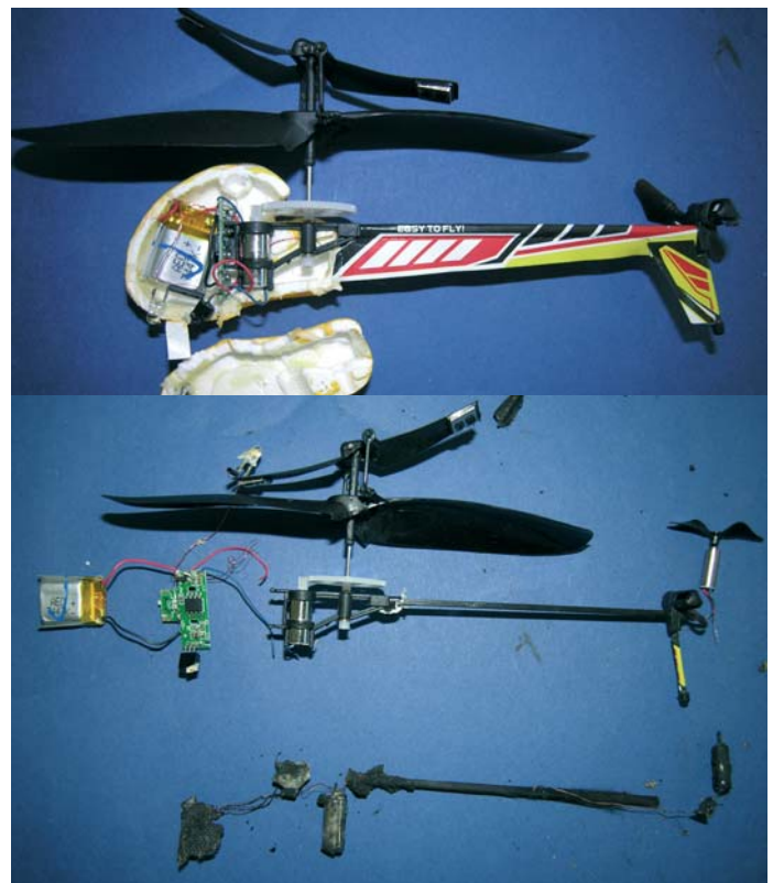
Reste des Hubschraubers (ganz unten) und das Vergleichsmodell
