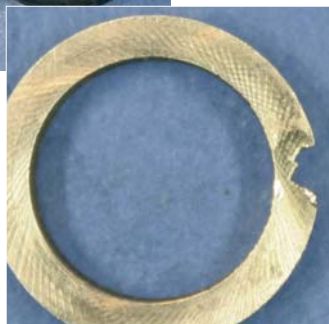
Klemmring, Druckscheibe und Dichtung (v.l.) aus der fehlerlosen Verschraubung. Rechts: Der Klemmring, der zum Schaden führte.
