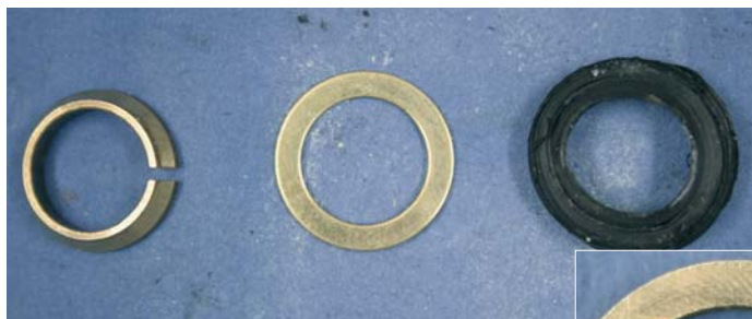
Klemmring, Druckscheibe und Dichtung (v.l.) aus der fehlerlosen Verschraubung. Rechts: Der Klemmring, der zum Schaden führte.
